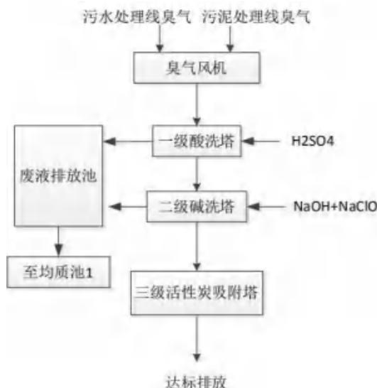
图 6.2-7 废水除臭系统工艺流程图
