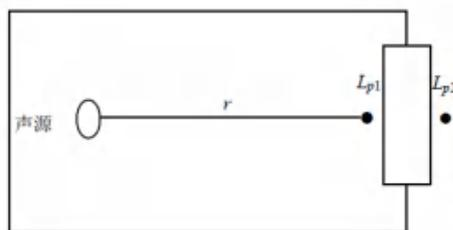
如上图所示, 声源位于室内, 室内声源可采用等效室外声源声功率级法进行计算。设靠近开口处 (或窗户) 室内、室外某倍频带的声压级分别为  $L_{p1}$  和  $L_{p2}$ 。若声源所在室内声场为近似扩散声场, 则室外的倍频带声压级可按公式 (A.6) 近似求出:
